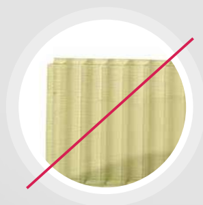
Vzorec 3 \Delta YI=10 - običajna garancija za večslojne PC plošče
