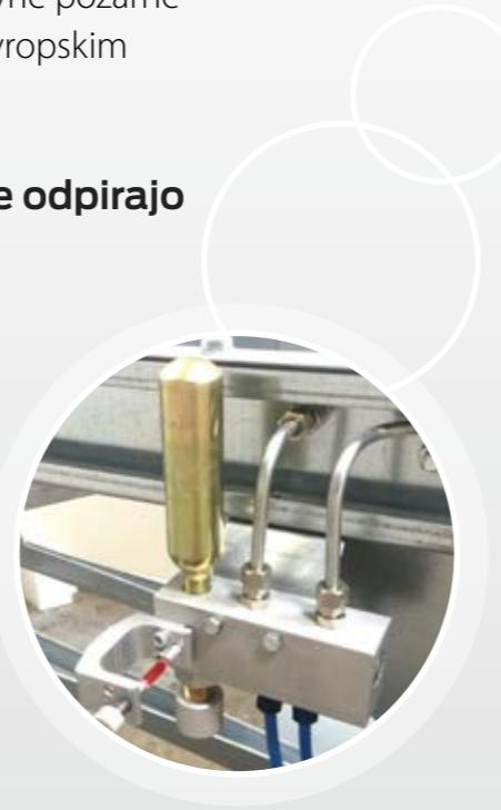
Prednost pnevmatskega NODT sistema je v neodvisnosti od kakršnegakoli električnega napajanja. Sistem deluje tudi v primeru popolnega izpada električne energije, saj je pogonski plin (CO<sub>2</sub>) shranjen v plinskih jeklenkah pod pritiskom. Iz tega razloga obstajajo tudi pnevmatski ODT -ji na stopničih. Ker lahko izpad električne energije vpliva tudi na sisteme za javljanje dima, se pnevmatski ODT sprožijo s pomočjo termičnih ampul z različnimi temperaturami sprožitve.
